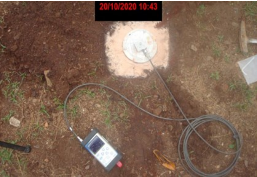
Acelerômetro, equipamento para medição de vibrações
