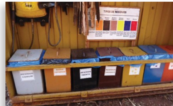
Sistema de acondicionamento de resíduos em praças de sondagem
