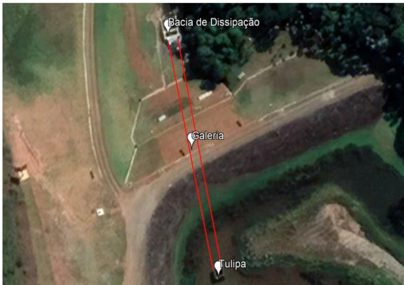
Figura 4-2 - Vertedouro Existente Tipo Poço e Galeria da Barragem do Quinzinho na condição anterior à implantação do sistema do vertedouro de soleira livre.
