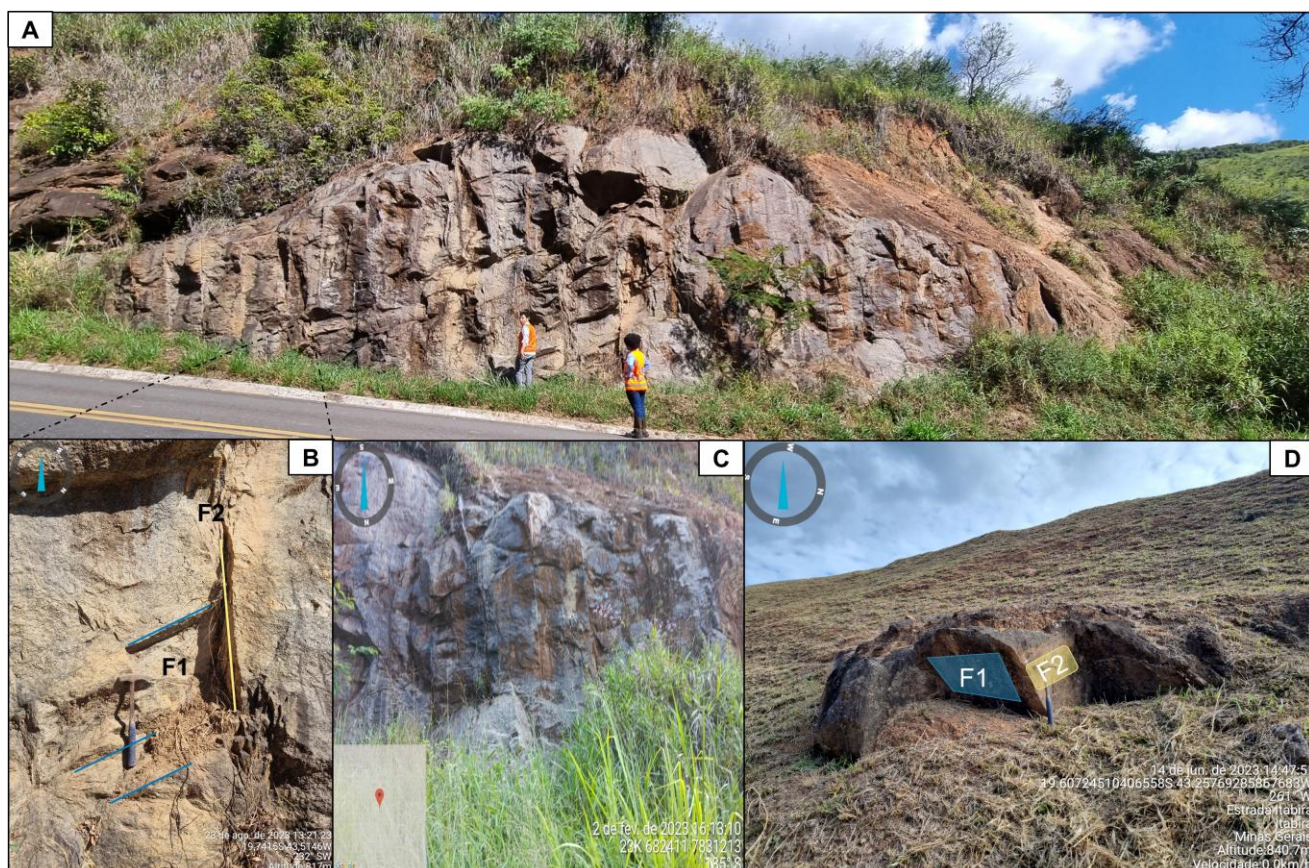
Figura 13-11 – (A): Afloramento em corte de estrada do Granito da Suíte Borrachudos no ponto 12 de mapeamento; (B): Intersecção das famílias de fratura mapeadas no afloramento; (C): Ponto de mapeamento 12 mostrando família de fratura mapeada; (D): Intersecção das famílias de fratura mapeadas no ponto 15 de mapeamento.
