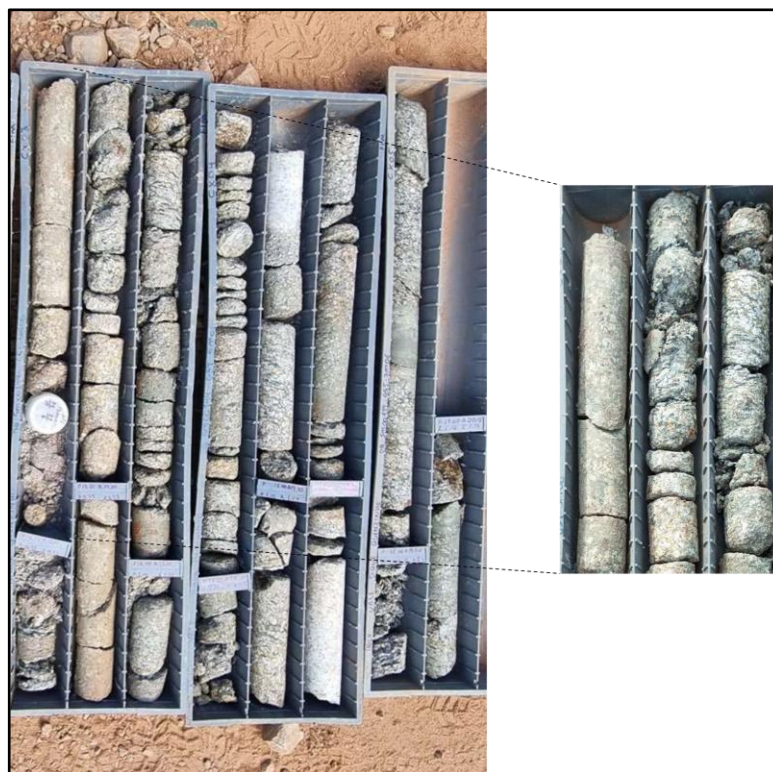
Figura 13-10 – Rocha alterada de granito da suíte borrachudos no furo GST-SM-06
