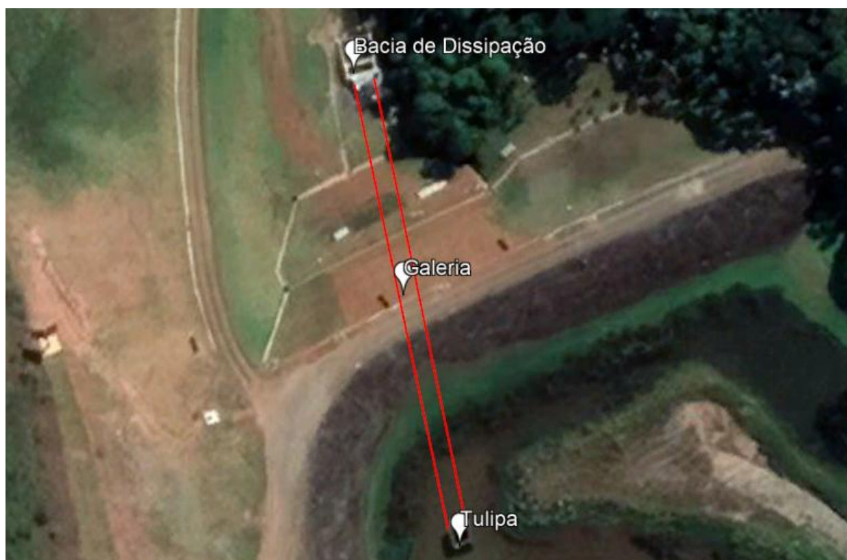
Figura 2.1 – Vertedouro Existente Tipo Poço e Galeria da Barragem Quinzinho.
