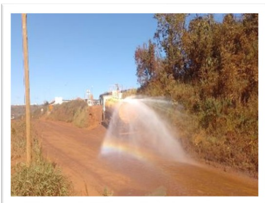
Umectação do acesso Vale, 2024
