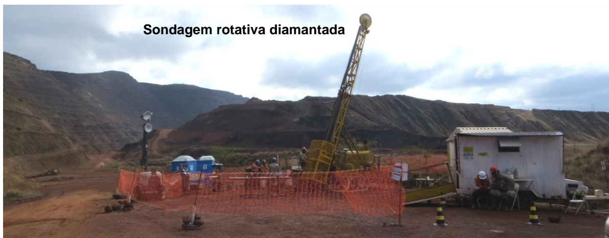
Foto 2.3.1.1: Foto elucidativa de uma praça de sondagem em operação.
