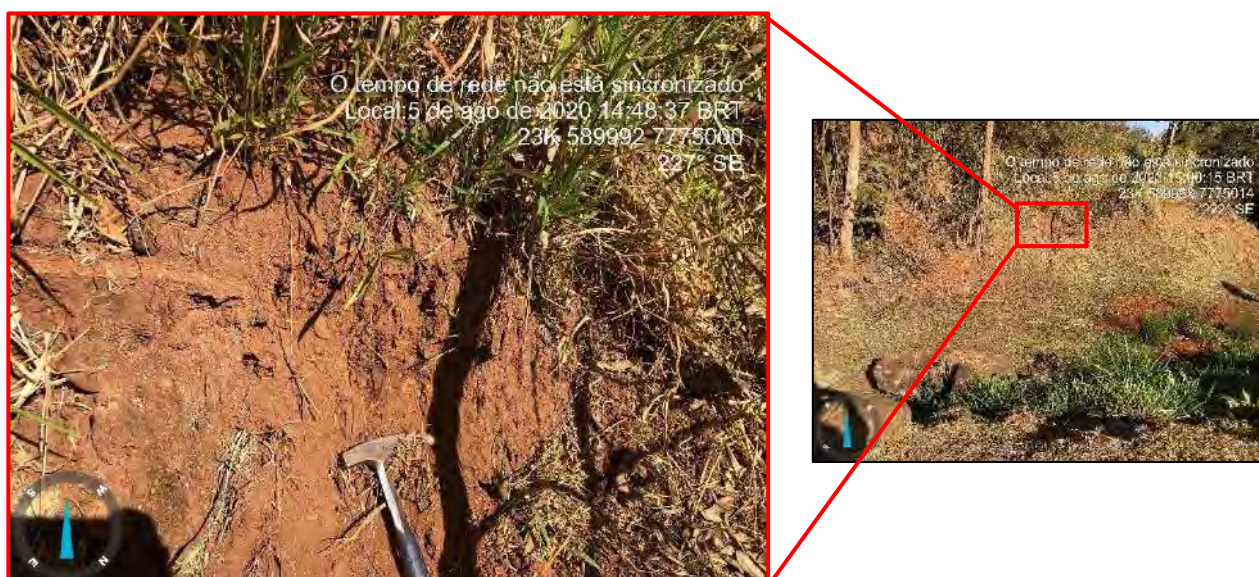
Figura 4-12 – Detalhe da região da ombreira esquerda a jusante, com solo coluvionar silto argiloso pouco arenoso (fino a médio) com clastos dessimétricos e presença de muitos detritos vegetais.
