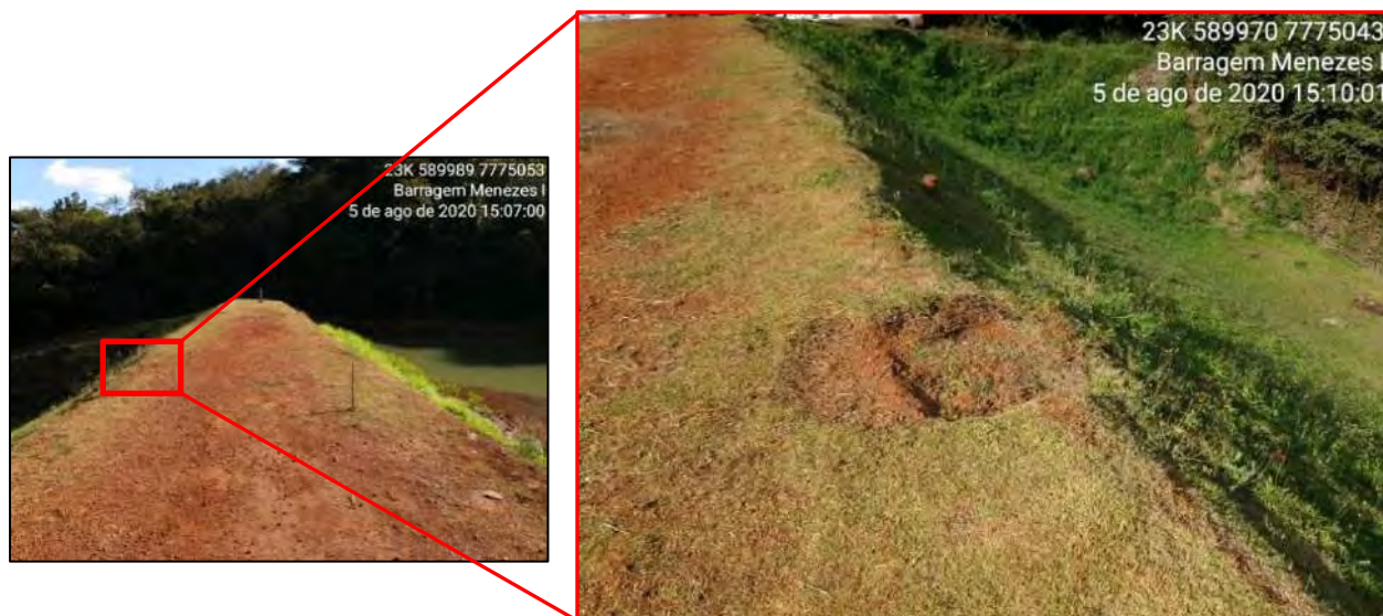
Figura 4-9 – Detalhe da região da crista onde ocorreu a retirada do bloco indeformado.
