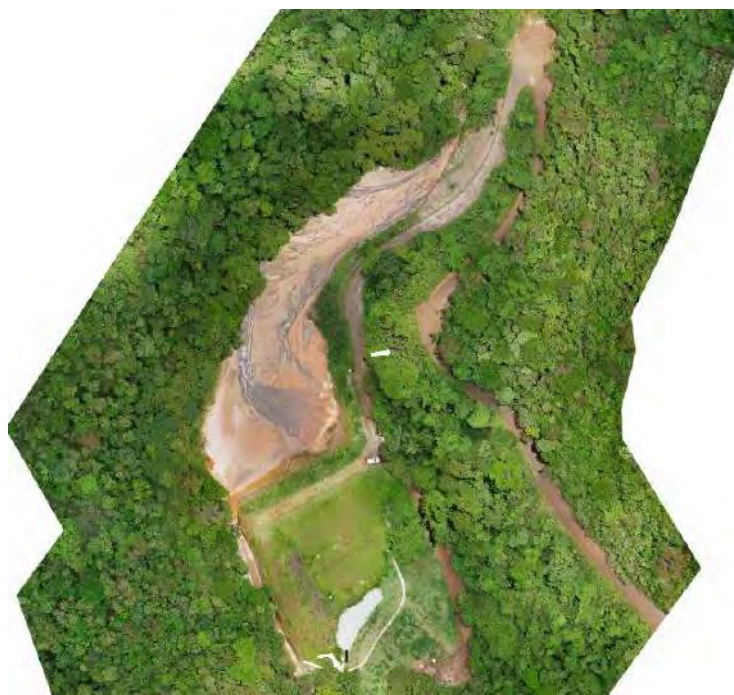
Figura 8.4: Assoreamento do Reservatório da Barragem Menezes I – Ortofoto de novembro de 2021 (Fonte: Rural Tech, 2021)
