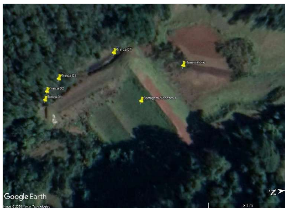
Figura 4-22 – Localização das trincas observadas “in-loco”.
