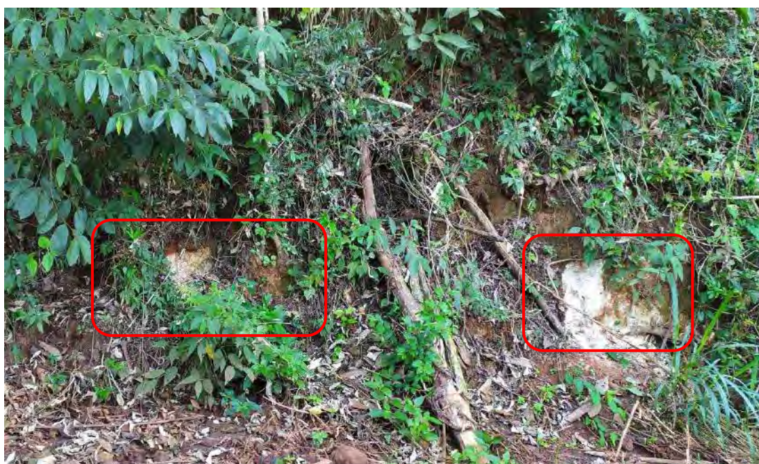
Foto 4.6 - Solo de alteração do Gnaiss em meio a cobertura coluvionar
