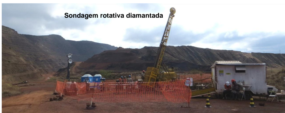
Foto 2.3.1.1: Foto elucidativa de uma praça de sondagem em operação.
