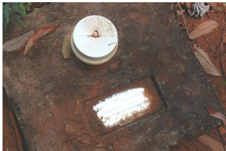
Foto 2.4.1.1: Foto ilustrativa de um marco de furo de sonda após pesquisa concluída (local desconhecido).
